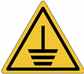
Conexión toma a tierra
